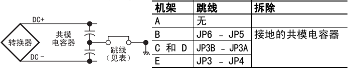
图 8 拆除接地的共模电容器
