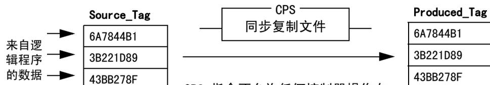
CPS 指令不允许任何控制器操作在复制过程中改变数据。试图中断 CPS 指令的任务延迟到复制完成。
