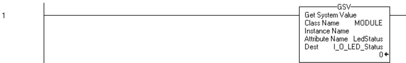
如果 I\_0\_LED\_Status = 2, 则至少有一个模块的通信超时 (错误)。GSV 指令设置 Module\_3\_Fault\_Code 为 Module\_3 的错误代码。
