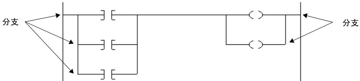
可以输入的并行分支层数没有限制。此示例显示一个具有五层的并行分支。主层是第一个分支层，后面是其他四个分支。
