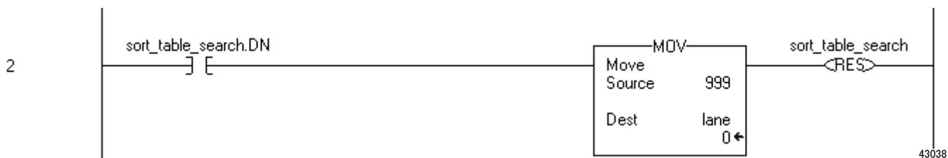
如果 FSC 指令没有在 `sort_table` 数组中找到产品 ID，指令将设置 DN 位。MOV 指令将 999 移动到通道标记中以通知控制器拒绝或重新发送项目。
