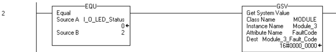
如果 Module\_3\_Fault\_Code. 不等于 0, 则与 Module\_3 的通信超时 (错误)。OTE 指令设置 Module\_3\_Faulted = 1。
